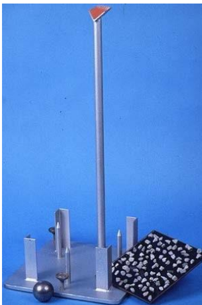
Figura 775 - 3. Dispositivo para ensayo, placa con la muestra y bola de acero
